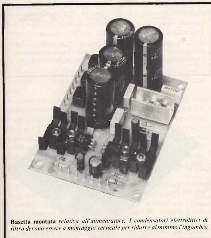
Fig. 14 - Disposizione componenti degli stadi illustrati nelle figure 4, 6, 7, 9; sul circuito stampato delle figure 11, 12.
