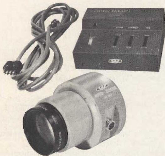
Fig. 3 - Circuito per il controllo a distanza della «testata» di una telecamera. Il sistema GBC mod. ERZL-1, agisce sulla messa a fuoco ottica, sullo zoom e sull'iride.
