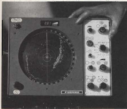
Fig. 21 - Nuovo radar navale, allo stato solido, di facile manutenzione e basso costo, alimentato a 12 ÷ 32 Vcc e 110 ÷ 220 Vca della FURUNO (SIRM).
