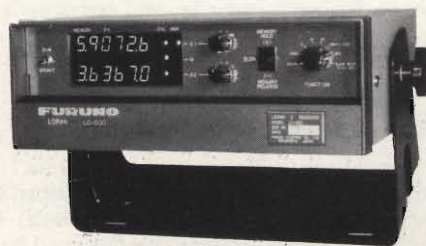
Fig. 8 - Apparato ricevente completamente automatico per il sistema LORAN C. Modello LC-200 della FURUNO (SIRM).
